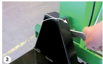
Pojistná páka na rámu A – zavřená
