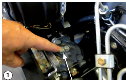
Odvzdušňovací šroub na palivovém filtru
