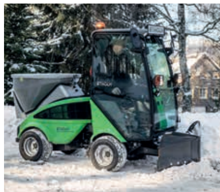
Lame chasse-neige en V et épandeur de sel et de sable
